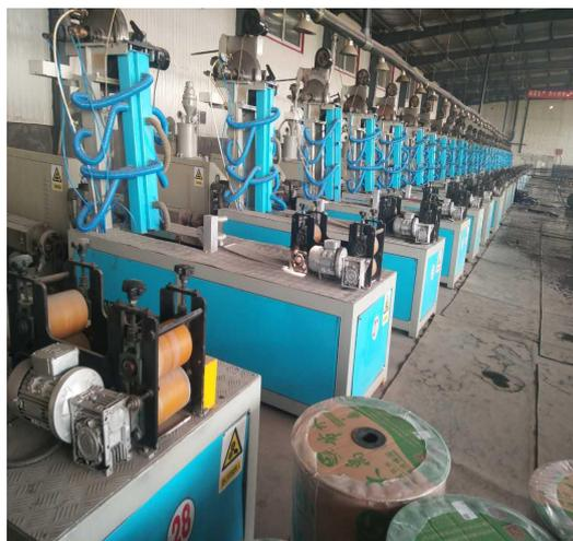
边缝式滴灌生产线（28条）
